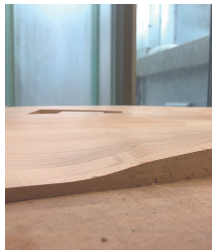
begradigtes Modell nach Fräsvorgang 2
